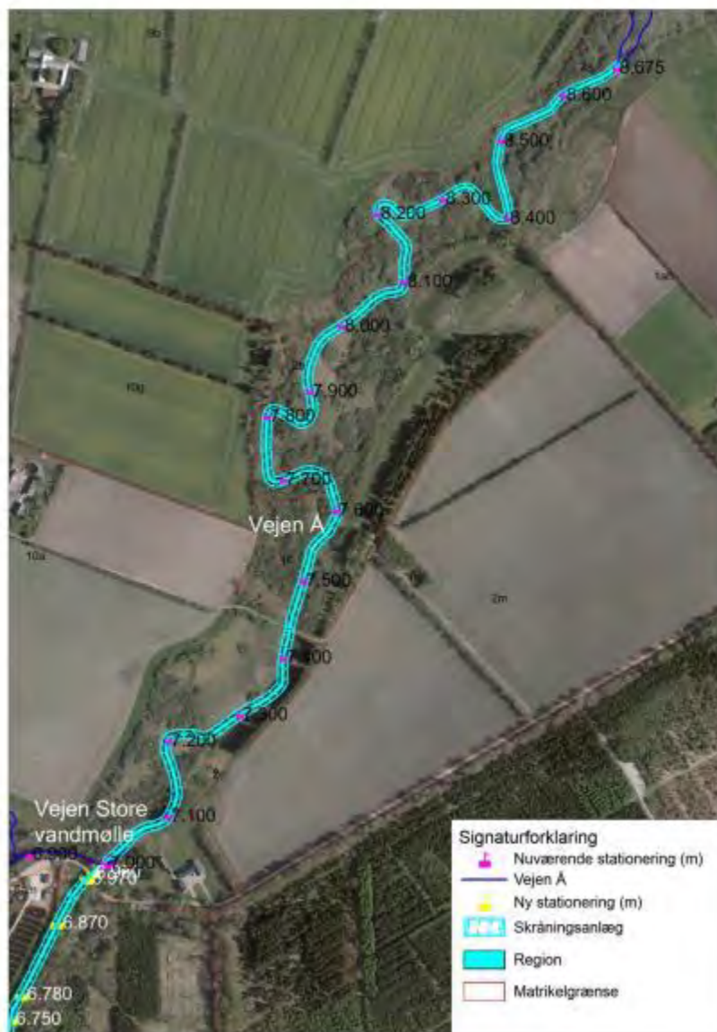
Figur 20: Sænkning af vandløbsbund opstrøms Vejen Store Vandmølle Dambrug.
