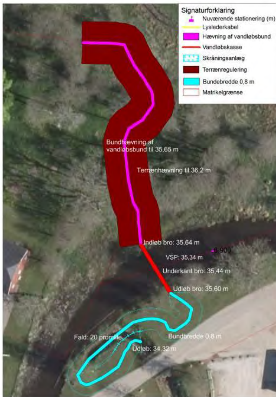
Figur 27: Projektforslag for etablering af faunapassage for Audiolagrøften.
